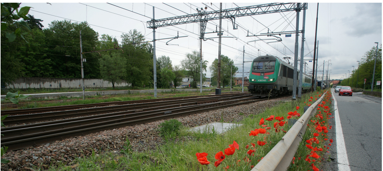
Treno "Modalohr" - trasporto autocarri completi - trainato da una coppia di locomotive policolorrente SNCF BB 36000 "Astride" ad Avigliana
