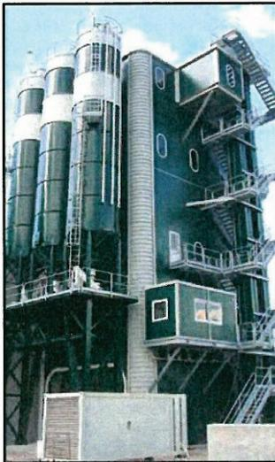
**Figura 35** - Impianto di betonaggio con silos verticali -
