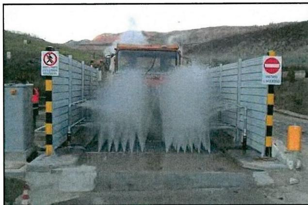
*Figura 41 -Lavaggio ruote (Fonte : <http://www.mobydick.com>)*
