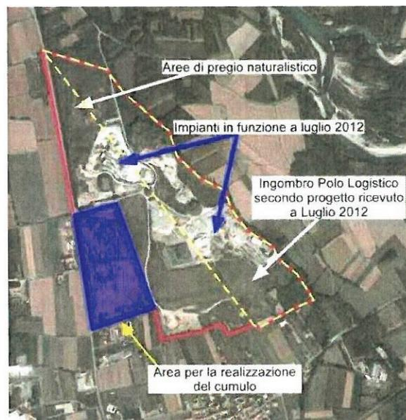
**Figura 70** – Criteri seguiti per la definizione del cumulo presso la cava nel comune di Torrazza P.te
