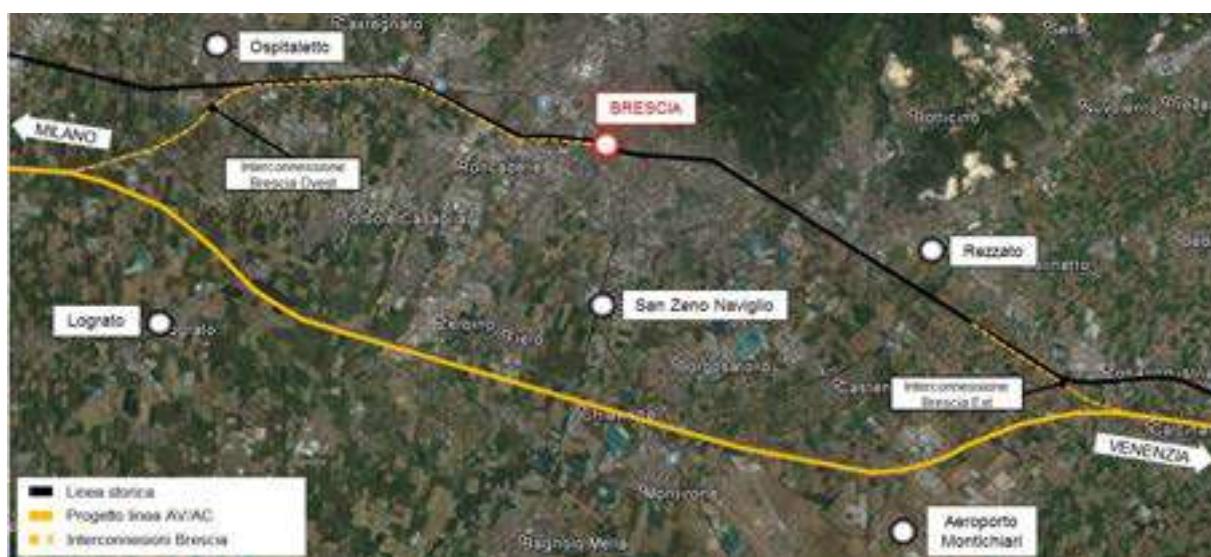
Figura 1- Tratta AV/AC Brescia-Verona: Tracciato previsto nel Progetto Definitivo avviato all'iter autorizzativo
