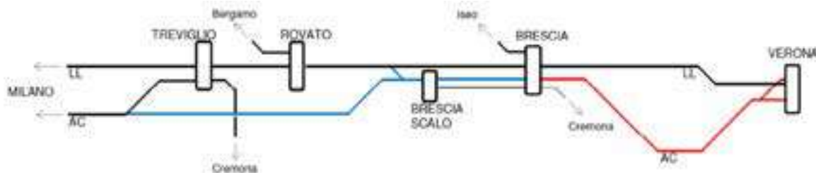
Figura 14 - Schema funzionale del collegamento Brescia - Verona
