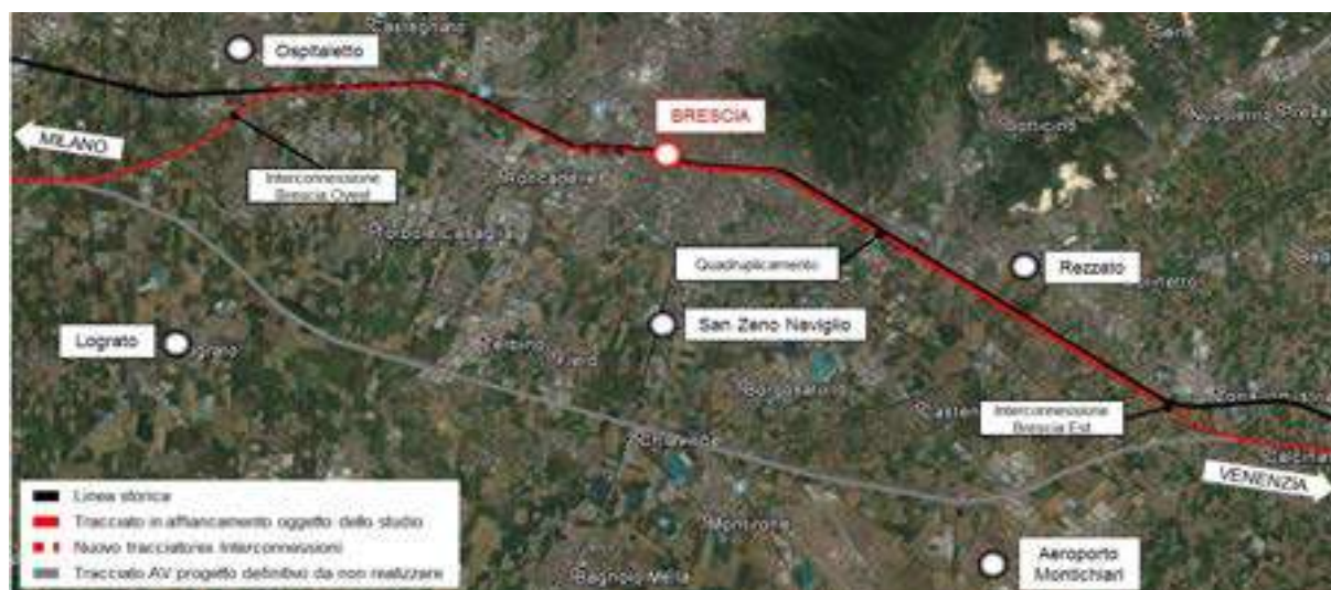
Figura 2 – Tratta AV/AC Brescia-Verona: tracciato alternativo previsto con il Quadruplicamento e considerato nella presente ACB
