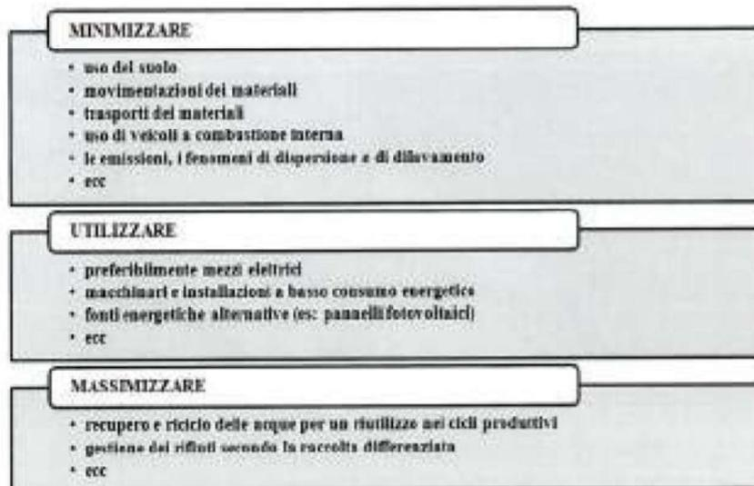
Figura 64 – Principi base per i cantieri
